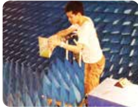
電波暗室でのアンテナ測定の様子
